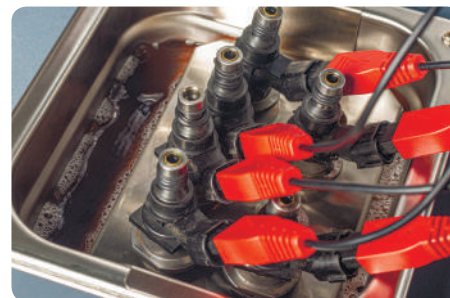
Промывка форсунок в УЗ ванне
