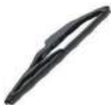
Щетка стеклоочистителя 400 мм (16") задняя каркасная, 5 адаптеров
